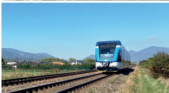
ŽOS Zvolen a.s. führt Revisions- und Generalreparaturen von dieselelektrischen Anlagen Stadler GTW 2/6 Baureihe D6460 durch und modernisiert auch teilweise nach Kundenwunsch. Die dieselelektrische Einheit D6460 besteht aus drei Teilen - zwei Endhauptsteuerwagen für den Personentransport und einem zentralen Hauptmotorteil.
